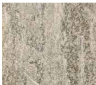
Zinkepoxi med Avantguard-tekniken (986 timmar)
