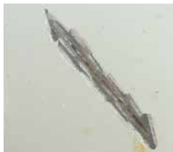
Komplett system med Avantguard-tekniken (1440 timmar)
