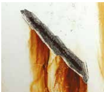
Komplett system utan Avantguard-tekniken (1440 timmar)
