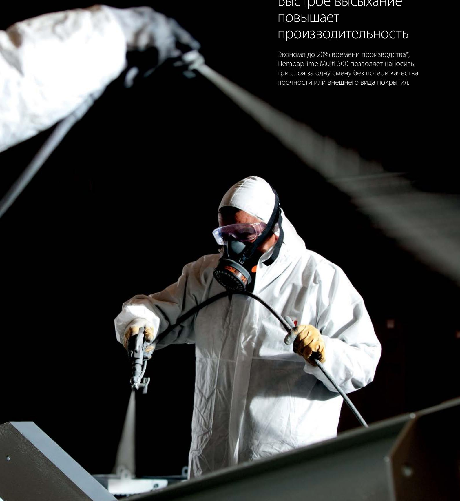
\*Расчет основывается на общем сокращении времени высыхания полноценной 3-слойной системы, состоящей из Hempadur Avantguard 750, промежуточного покрытия и Hempathane HS (время перекрытия плюс время высыхания на отлив финишного слоя при 20°C) с использованием Немпаприме Multi 500 в качестве промежуточного покрытия вместо Hempadur Mastic.
