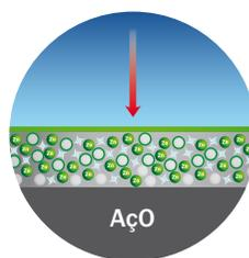
**O efeito inibidor potencia a proteção anticorrosiva**
