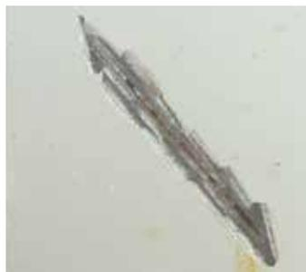
Système complet avec la technologie Avantguard (1440 heures)
