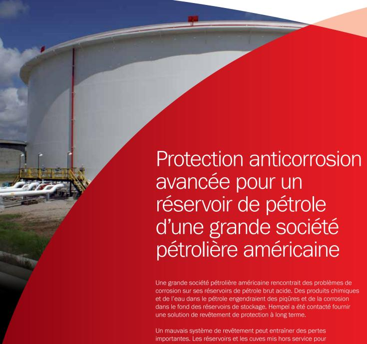
Un mauvais système de revêtement peut entraîner des pertes importantes. Les réservoirs et les cuves mis hors service pour réparation font perdre du temps et des revenus à leurs propriétaires. Les revêtements Hempaline à base de résine vinylester ont été conçus pour résister aux acides, aux agents caustiques, aux solvants puissants, au pétrole et à l'eau, afin de protéger les installations et préserver la pureté du contenu du réservoir.
