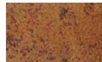
**D** Superficie de acero de la que se ha desprendido la totalidad de la cascarilla de laminación y en la que se observan picaduras a simple vista.
