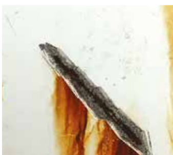
Fuldt system uden Avantguard teknologi (1440 timer)
