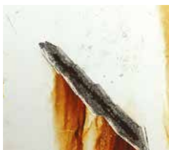
Ciclo completo senza tecnologia Avantguard (1440 ore)
