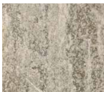
Epossidico allo zinco con tecnologia Avantguard (986 ore)
